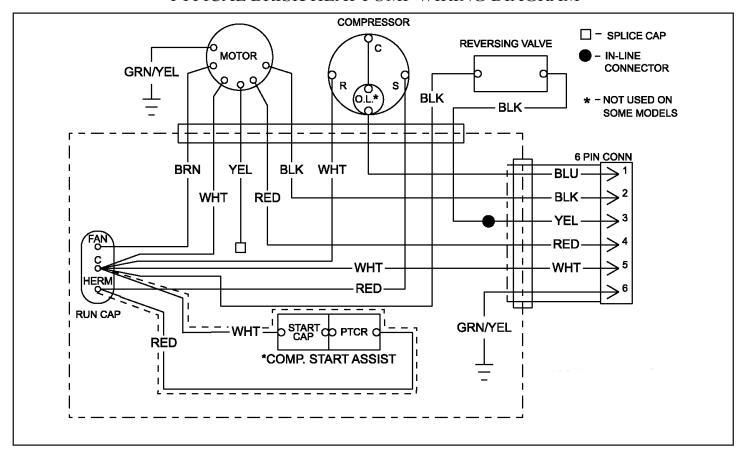
TYPICAL CCC 2 PENGUIN HEAT PUMP WIRING DIAGRAM
