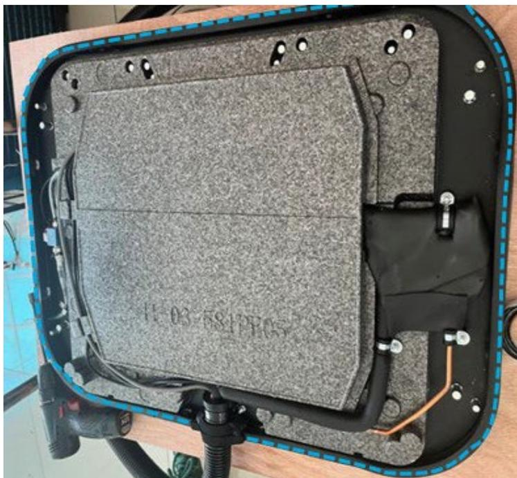
2. Posizionare il coperchio superiore in plastica sull'unità, tirare il coperchio superiore sul bordo esterno del nastro sigillante adesivo e assicurarsi che il nastro si trovi sotto il coperchio superiore in plastica.
