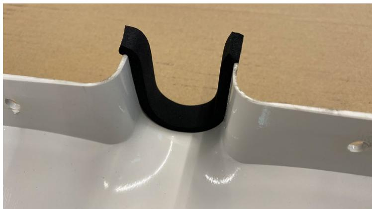
2. Posizionare il nastro sigillante (1) circondando la parte interna del coperchio superiore, come illustrato in figura. Se necessario, tagliare il nastro sigillante in eccesso (1) e collegare il nastro sigillante (1) al nastro sigillante più piccolo (2) da un lato all'altro.
