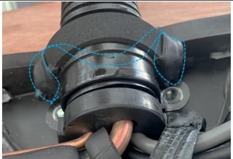
4. Coloque 1 pieza de cinta de sellado (2) en el tubo corrugado, a lo largo del borde de la primera cinta de sellado.
