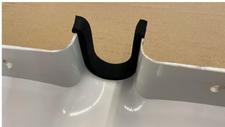
2. Coloque la cinta de sellado (1) alrededor del interior de la cubierta superior, tal y como se muestra. Corte el exceso de cinta de sellado (1) si es necesario y una la cinta de sellado (1) a la cinta de sellado pequeña (2) de extremo a extremo.
