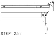
CUT OFF THE SEALING PLUG AT THE LEVEL OF THE DOOR PAN (DOOR PANS).
