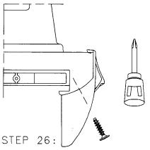
MOUNT THE HANDLE ON THE DOOR (DOORS). THE HANDLES ARE TO BE LOCATED NEAREST THE CENTRAL GIR-DER BETWEEN THE DOORS ON 2-DOOR REFRIGERATORS OR AT THE TOP OF THE DOOR ON 1-DOOR REFRIGERATORS.
