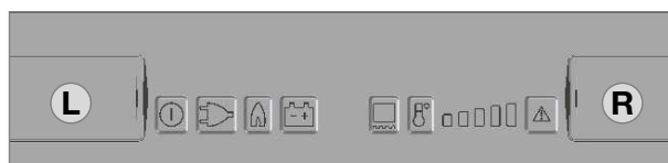
Pannello comande con vano batterie (L, R)
