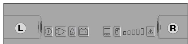
Käyttöpaneelissa kaksi paristolokeroa (L, R), optio
