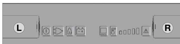
betjeningsblenden med batterirommet (L, R)
