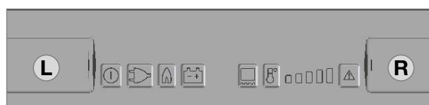
Manövreringsskyddet med batterifacket (L, R)
