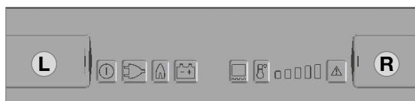
Kontrolpanelet med batterifaget (L, R)
