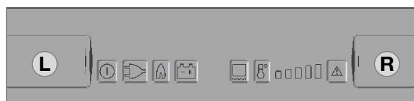
Pannello comande con vano batterie (L, R)
